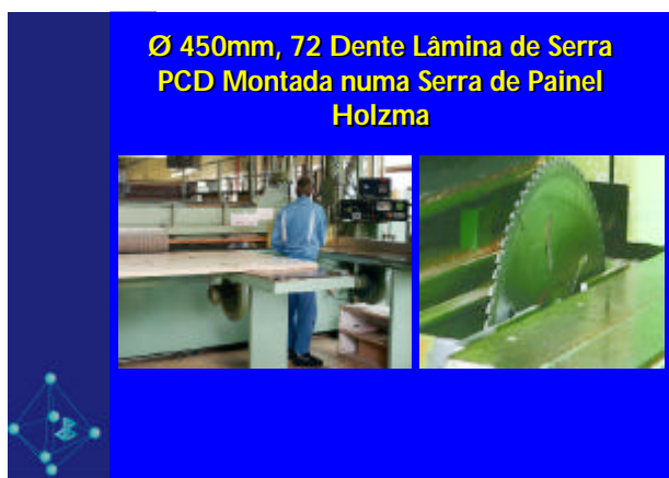
Figura 3. Serra de painéis com 450mm diâmetro, com 72 insertos de PCD montada num Holzma EL70/5/4300
