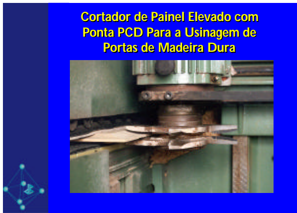
Figura 5. Fresa para painéis suspensos com insertos de PCD para usinagem de portas de madeira dura.
